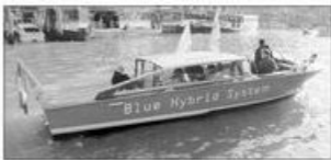
MINUTE D'ORA Il basso impatto del taxi equipaggiato con motore ibrido elettrico-diesel
